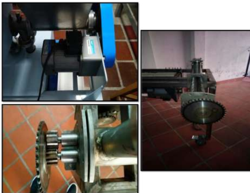
Figura 36. Sistema de transmisión de potencia.
