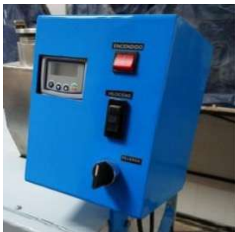
Figura 19. Sistema eléctrico con la cubierta.
