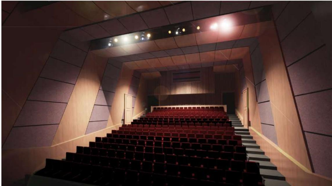
Como parte del diseño acústico del auditorio, se incorpora un difusor compuesto por una pared alistonada de madera de pino de 4 cm de grosor, combinado con un fondo acústico de lámina tipo *black theater* de 1". Esta solución no solo añade un elemento estético y funcional al espacio, sino que también optimiza las condiciones acústicas generales del recinto.
