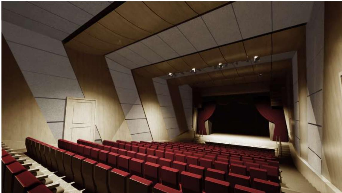
El diseño no culmina en un techo plano convencional; en su lugar, las láminas de MDF se transforman en nubes policilíndricas acústicas suspendidas. Estas estructuras no solo aportan un elemento escultórico y moderno, sino que también optimizan la dispersión del sonido y controlan las reverberaciones, proporcionando una experiencia auditiva de calidad superior. Además, las nubes contribuyen a la creación de un ambiente cálido y envolvente, potenciando la percepción espacial del recinto.
