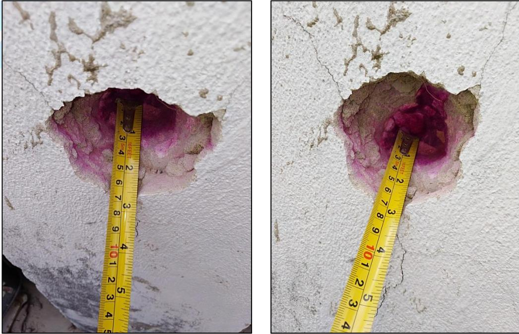
Imagen No. 118: Ensayos de carbonatación en columnas a 6 cm – Muestra #3 – Bloque B9
