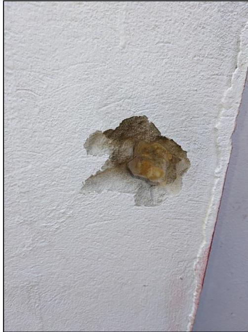
Imagen No. 107: Bloque B8 – Ensayo de carbonatación a 3 cm – Muestra #2.
