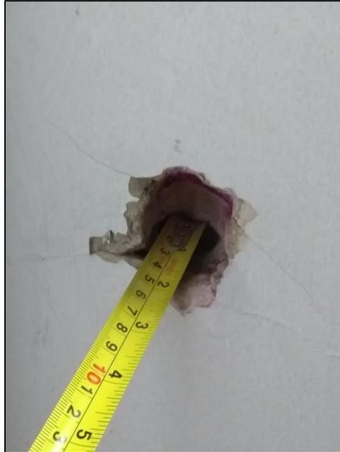
Imagen No. 47: Ensayos en columnas perimetrales de la zona del escenario – Muestra No.4 del Teatro a 4.5 cm de profundidad
