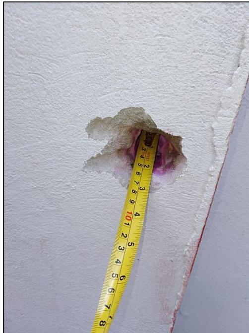
Imagen No. 108: Bloque B8 – Ensayo de carbonatación a 6 cm – Muestra #2.
