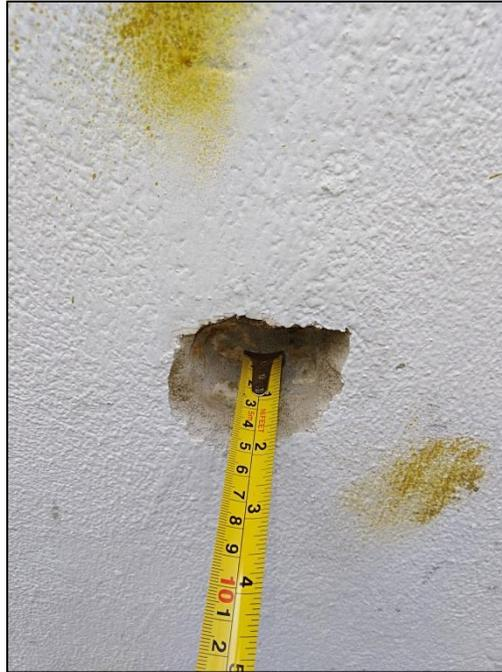
Imagen No. 114: Ensayos de carbonatación en columnas a 3 cm – Muestra #1 – Bloque B9
