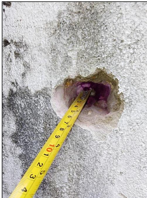
Imagen No. 117: Ensayos de carbonatación en columnas a 6 cm – Muestra #2 – Bloque B9
