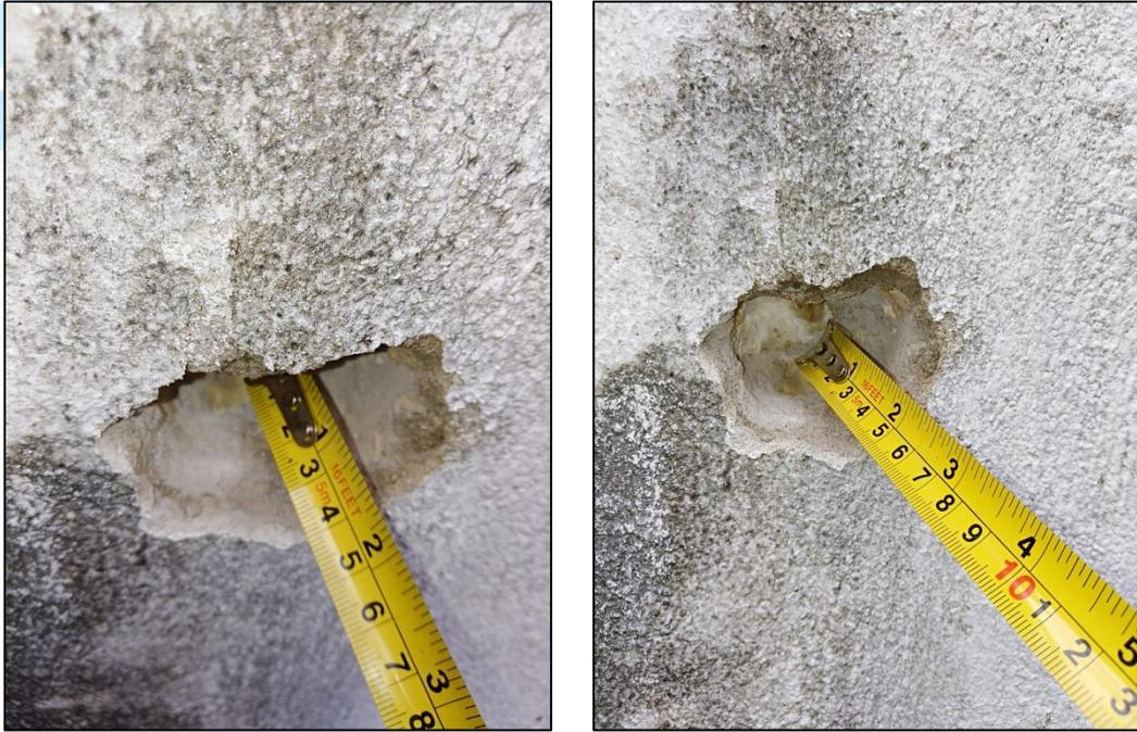
Imagen No. 116: Ensayos de carbonatación en columnas a 3 cm – Muestra #2 – Bloque B9
