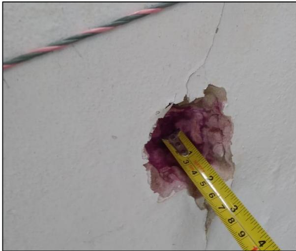
Imagen No. 43: Teatro – Ensayos de carbonatación en columnas del looby.
