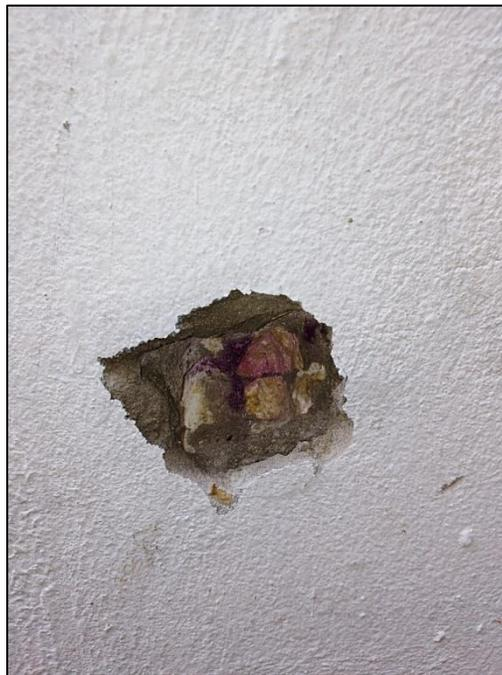
Imagen No. 106: Bloque B8 – Ensayo de carbonatación a 6 cm – Muestra #1.
